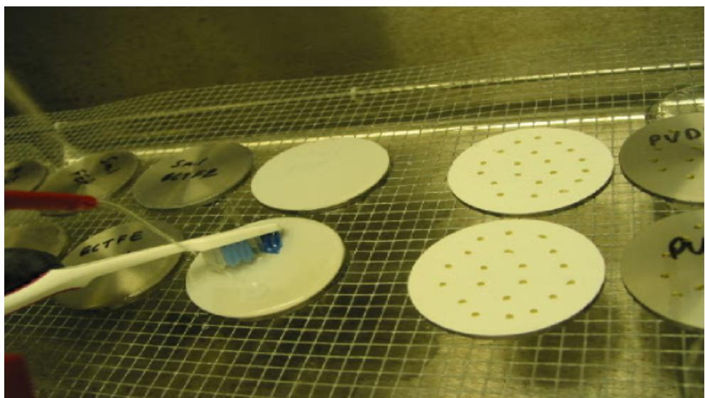
**Figure 2 – Decontamination Scrub with DS2**
